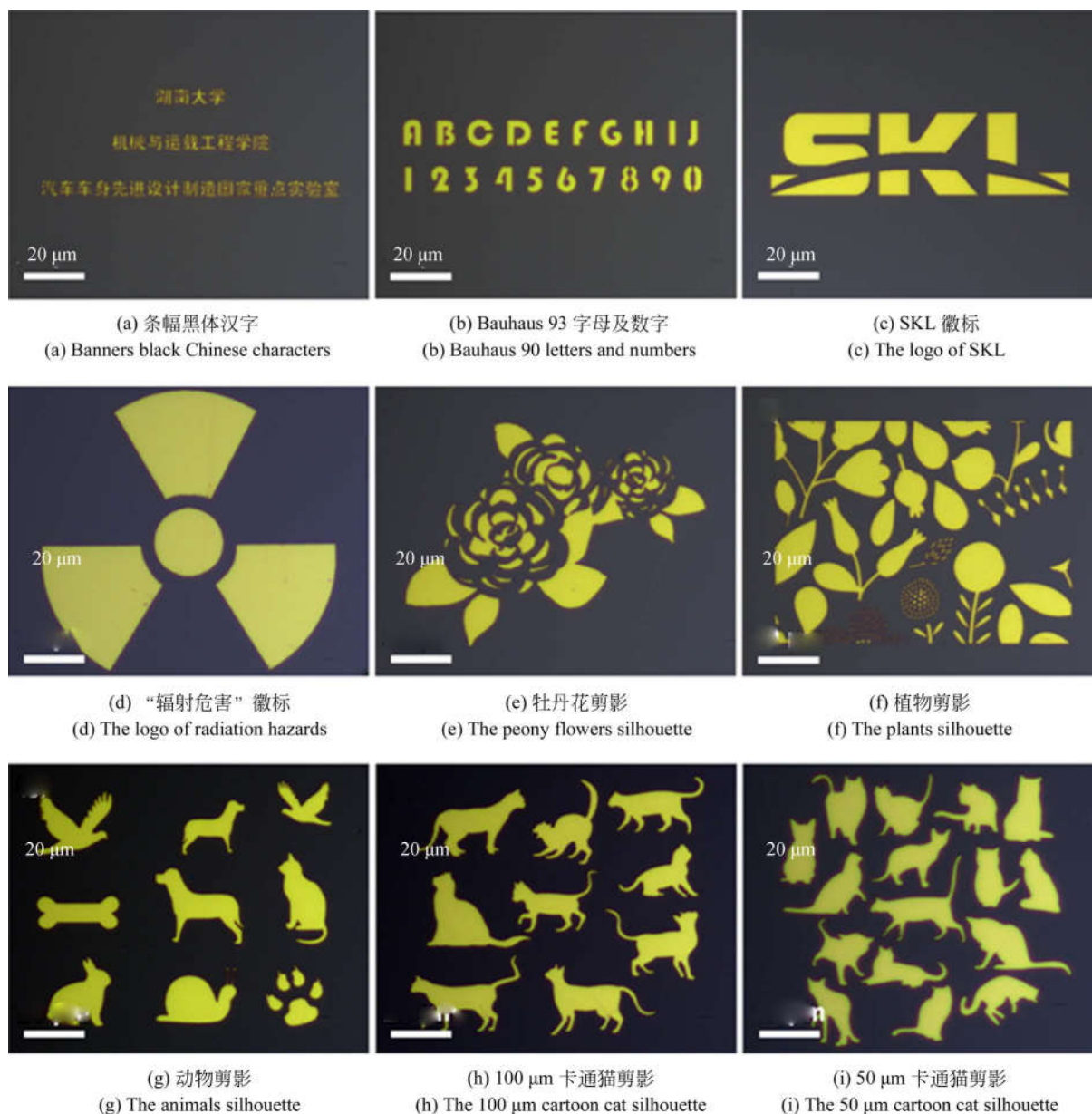
图5 利用本文所提方法得到的曝光版图结合 SPL 工艺制备出的不同图形的光学图像
