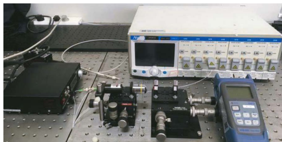
图 6 空间光耦合实验系统
