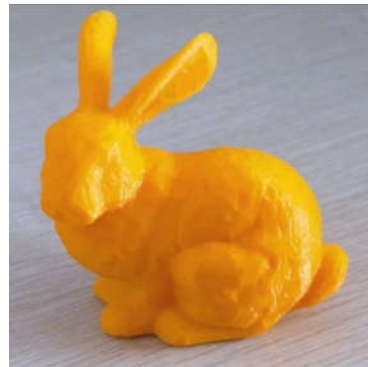
(b)简化模型制造结果(90%简化)
