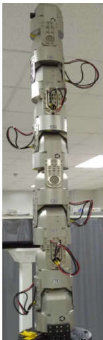
图 1 九自由度超冗余机械臂
