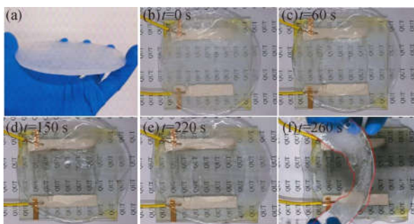
图 13 电加热玻璃化冰效果测试
