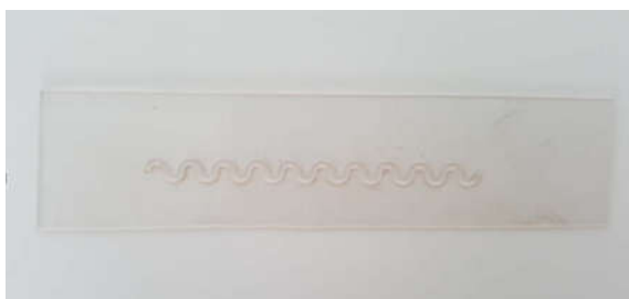
图 5 切割后的马蹄形 PDMS 模具 Fig. 5 Horseshoe PDMS mold after cutting
