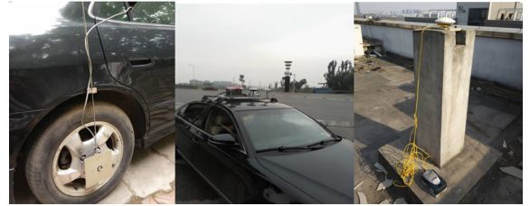
图 3 车载组合导航系统安装图
