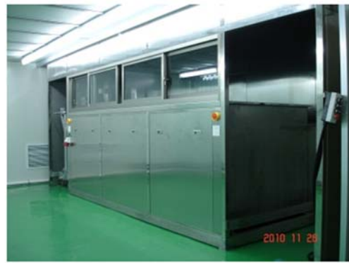
图 4 大口径光学镀膜基片的清洗装置
