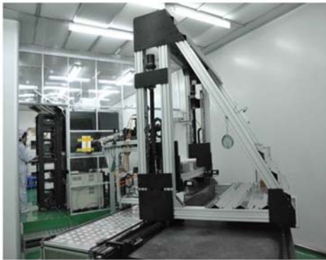
图 5 上海光机所研制的国内首套大口径光学元件激光预处理平台
