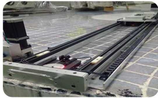
图 3 环抛机平面度实际测量图
