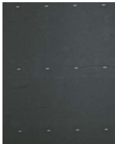
图 5 8 \text{ keV} 能量下硬 X 射线波带片阵列在 X 射线 CCD 上的聚焦图像
