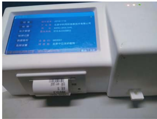
图 6 降钙素原胶体金试纸条显色分析仪
