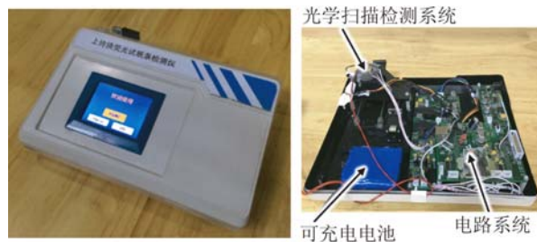
图 7 便携式上转换荧光试纸条检测仪样机外观及内部结构
