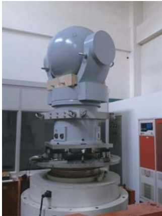
图 4 光电跟踪系统振动试验
