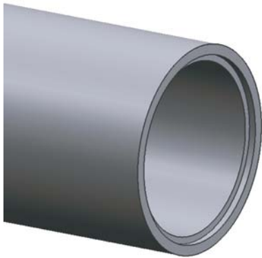
图 4 碳纤维支撑杆端头处的定位止口
