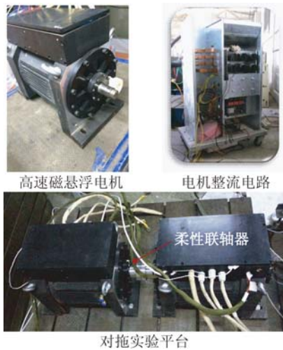
图 13 样机试验平台
