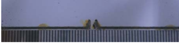
图 9 沉积成形的半波偶极子天线
