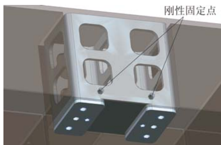
图 4 碳纤维框架与钛合金预埋件的刚性固定点
