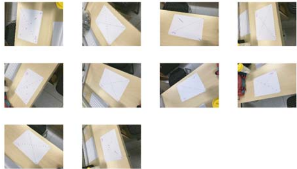
图 2 iPhone6s 获取的一组不同姿态的标定图像
