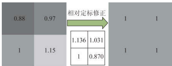
图 2 CCD 相对定标原理示意图
