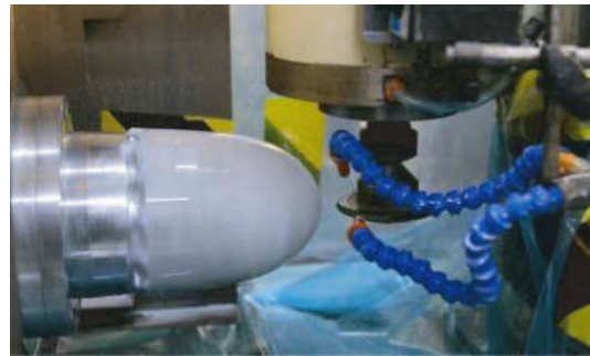
图 12 ALON 高陡度薄壁保形非球面的磨削过程照片
