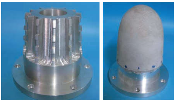
图 8 精密夹具及装夹后的 ALON 工件毛坯 Fig. 8 Precision jig and chamfered ALON workpiece
