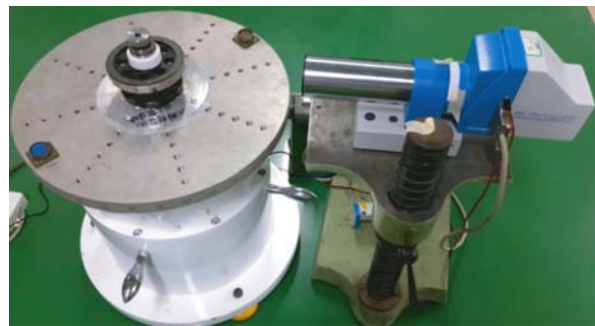
图 9 单轴转台定位精度测试验证实验
