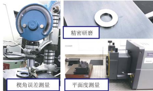
图 8 垫圈楔角误差和平面度的精密测试装置
