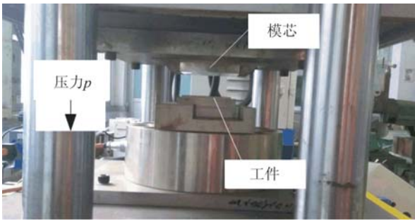
图 4 热压微成型的实验装置
