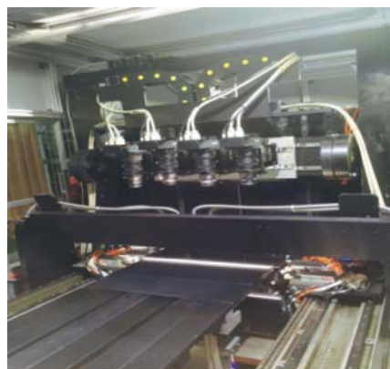
图 6 基于气浮支承的玻璃基板检测原理样机
