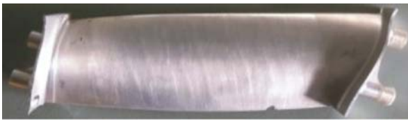
(a)CAM 软件规划路径抛磨效果
