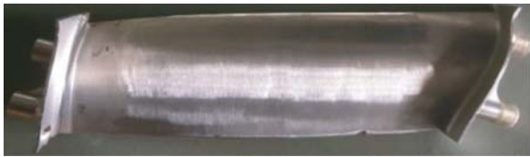
(b)基于 NURBS 曲面规划的路径抛磨效果
