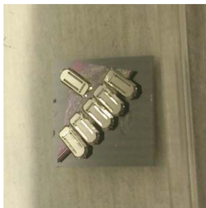
图 6 PLD 实验中 AFM 探针的安置方法示意图
