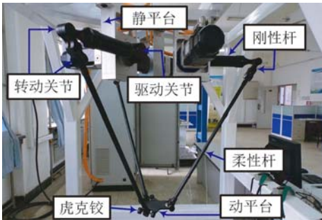
图 3 3-RRRU 刚柔耦合并联机器人
