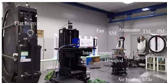
图 6 离轴三反系统自准直干涉检测光路实物图
