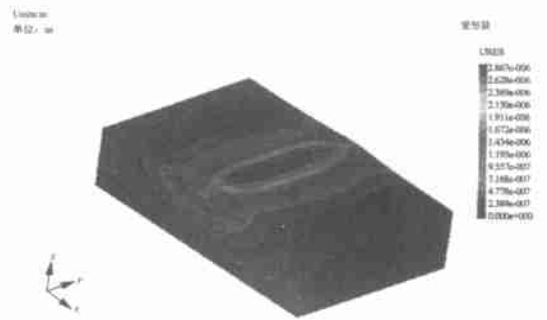
图 11 曲顶槽式结构变形情况
