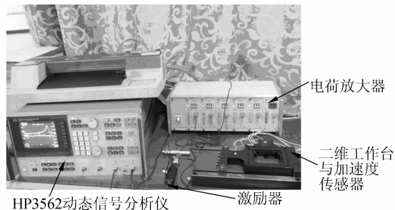
图 3 微定位工作台动态测试试验装置
