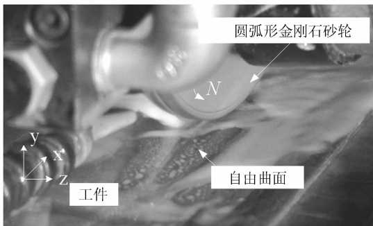
图7 自由曲面的成型磨削试验现场
