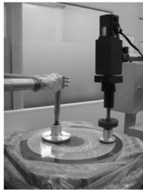
图 1 多模式组合抛光 \Phi 510 mm 离轴抛物镜
