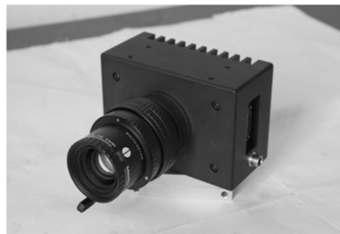
图 10 大幅面扫描仪上自制的 CCD 相机 Fig. 10 CCD camera on large format scanner
