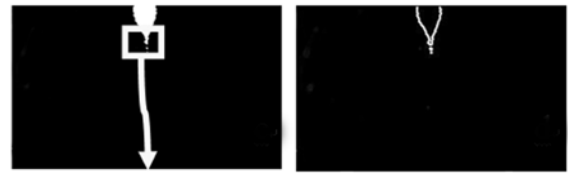
(c) 去噪后的二值图像 (c) Binary image without noise (d) Canny 边缘提取 (d) Canny edge extraction
