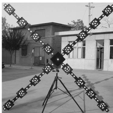
图 2 标定十字架 Fig. 2 Cross-shaped calibration target
