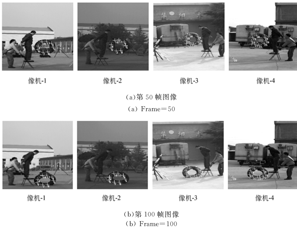
图 9 四台像机捕捉的部分时刻轮胎运动变形图像
