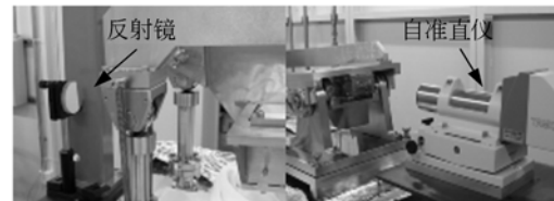
图 5 光斑水平漂移重复精度现场检测
