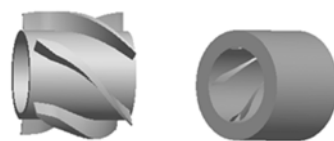
图 5 5 叶片涡轮及对应全流道模型
