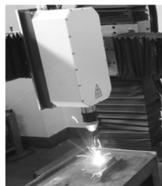
图 13 半导体激光器在实际加工中的应用 Fig. 13 Application of diode lasers in laser welding
