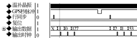
图 6 相机时间测试仪时序仿真结果
