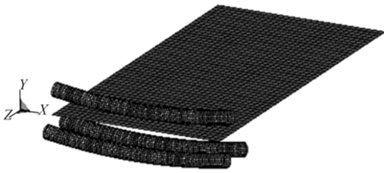
图 4 双曲率件有限元模型 Fig. 4 FEA model of double curvature part
