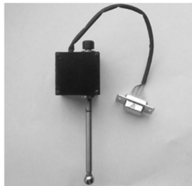
图 7 角位移测量装置实物
