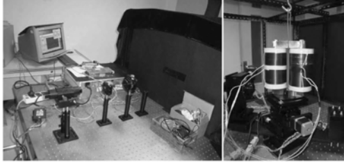
图 2 表面增强磁光效应谱仪实物图
