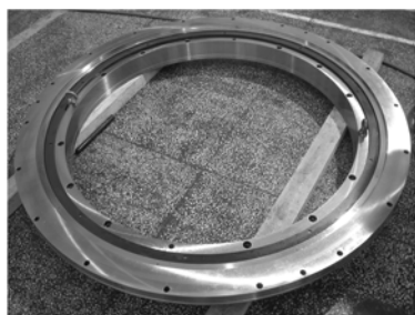
图 12 1 500 mm 一体化方位轴承样机
