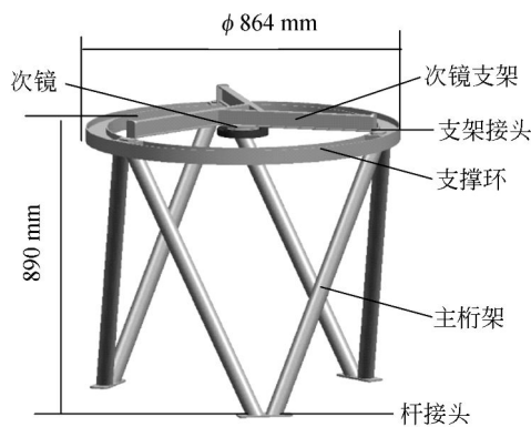
图 2 轻型空间遥感器支撑桁架结构
