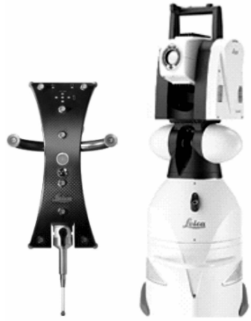
图 5 Leica 激光跟踪仪测量系统(左:T-Probe)
