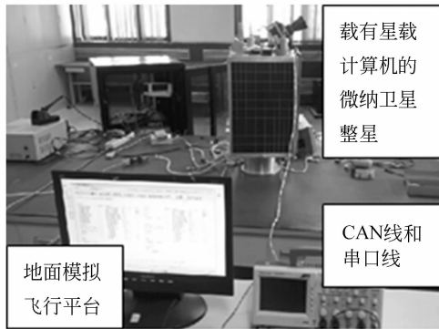
图 2 姿态控制软件实时测试系统实物图
