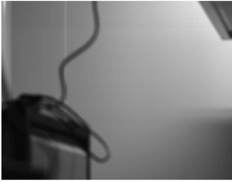
图 4 日光灯照明环境中 TDI CCD 无背景条纹的视频 Fig. 4 Picture without background fringes from TDI CCD in illumination of fluorescence lamp
