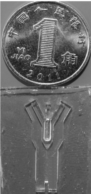
图 7 封装后的微流控芯片照片
