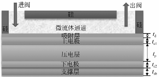
图 4 FBAR 毒品检测传感器结构示意图
